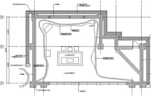
성모당의 뒤편 벽돌벽 상부에 300×425mm 크기의 직사각형 환기구를 3개 설치했습니다. 이는 인공 동굴 내부의 환기를 위한 것으로 여겨지고, 외부에서는 출입할 수 없는 구조입니다. 전면에서 출입이 가능한 인공 동굴의 내부에 재단이 설치되어 있고 성모상은 인공 동굴 암벽 위에 구멍을 만들어 설치했습니다. 이 인공 동굴은 네덜란드의 발켄부르크의 동굴, 루르드 천연 동굴과 거의 비슷합니다. 다만 성모 동굴의 구성을 위해 외부에 벽돌조로 뼈대를 형성하고, 천연 동굴의 모습을 재현하기 위해 내부를 나무로 짠 트러스로 비정형적인 틀을 형성했고, 목조 거푸집을 형성한 후 콘크리트로 인공암반 모습으로 만들었습니다.
